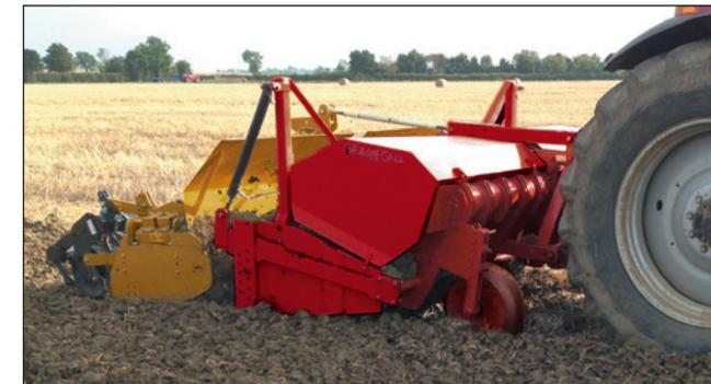
**IT** La presa di potenza posteriore e l'elevata robustezza del telaio permettono l'abbinamento di macchine aggiuntive per la preparazione immediata del letto di semina.
